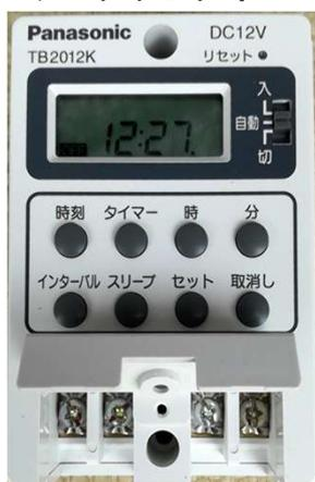
(1個) . . . LEDを指定した時間のみ自動点灯させる装置
